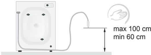
Der Abwasserschlauch befindet sich an der Hinterwand der Waschmaschine. Den Abwasserschlauch so absichern, dass er sich während des Betriebs der Waschmaschine nicht hin und her bewegt (den Bogen einsetzen - siehe unten). Den Abwasserschlauch nicht zu tief in das Abflussrohr einschieben!
